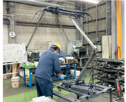
パンタグラフの検査
