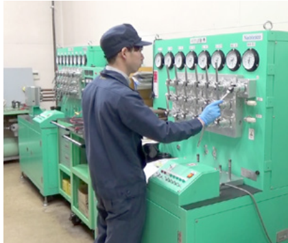
ブレーキ装置の検査
